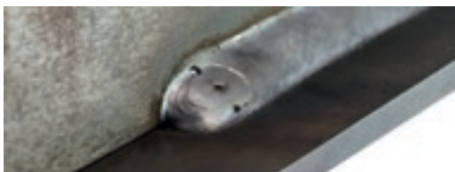
Mit Endkraterfüllung – perfektes Nahtende.
