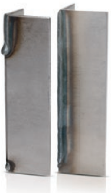
Eine geschweißte Ecknaht im Vergleich. Standard-Lichtbogen (links): Sehr schnell vorlaufendes Schmelzbad, kurz vor dem Herunterfallen. SpeedCold (rechts): Komplet, sicher und schnell geschweißt (35 cm/min).
