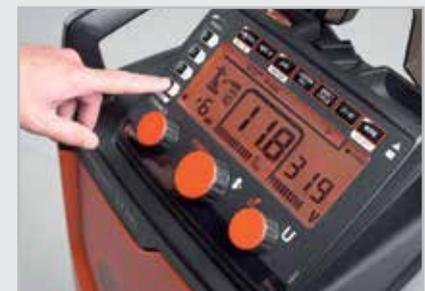
*Die Kempact Adaptive-Modelle (mit A gekennzeichnet) bieten spezielle Merkmale. Dazu gehören die Stromregelung je nach Blechdicke, Auswahl der Zusatzwerkstoffe und Speicherkanäle.*
