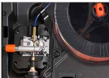
Die Kempact 181/251-Modelle verfügen über den GT02C-Drahtvorschub mit zwei Rollen.
