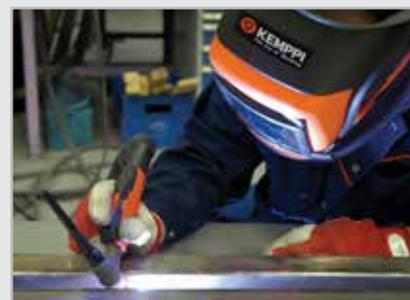
Schweißen mit der Funktion MicroTack führt auf einfache, schnelle und präzise Weise zu besserer Qualität und Produktivität bei einzelnen Schweißaufgaben. Extrem wirksam bei sehr dünnen Materialien.
