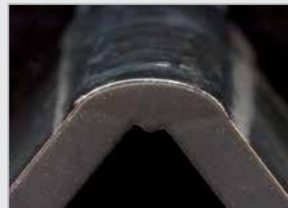
Ein stabiler Lichtbogen sorgt für eine gleichförmige Schweißnaht und gewährleistet gute mechanische Eigenschaften der Schweißverbindung.
