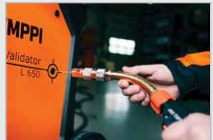
*ArcValidator verfügt zudem über eine integrierte Messvorrichtung für die Drahtvorschubgeschwindigkeit.*
