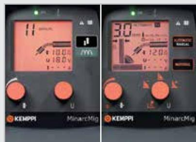
Die Modelle MinarcMig Evo 170 und 200 verfügen über LCD-Bedienpaneele. Die MinarcMig Evo 200 ermöglicht auch die Auswahl der Materialart, Blechdicke und Schweißnahtform.
