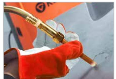
Die HotSpot™-Funktion erleichtert und vereinfacht Metallschrumpfung und Erwärmung einzelner Teile.
