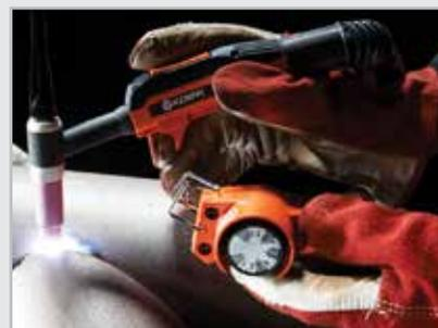
Die R 10 Handfernbedienung bietet eine bequeme Steuerung der Stromstärke für WIG- und E-Hand-Schweißarbeiten.
