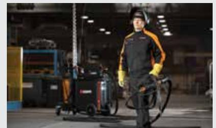
Das leichte Zwischenvorschubgerät ist eine ergonomische Alternative zu schweren und großen Drahtvorschubgeräten oder das Schweißen mit schweren Push/Pull-Schweißbrennern, die das Handgelenk des Schweißers stärker belasten.
