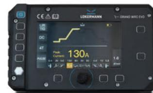
Einphasige und dreiphasige Invertergeneratoren für das WIG-DC- und AC/DC-Schweißen. Ausgestattet mit Sensoren für Temperatur-, Spannungs- und Strom, so dass sie gegen Schwankungen der Versorgungsspannung geschützt sind. Robust und mit einer hohen Einschaltdauer sind sie ideal für den industriellen Einsatz.
