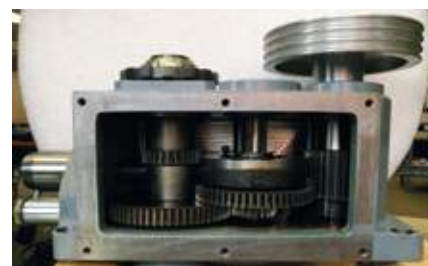
Scatola ingranaggi in bagno d'olio.
